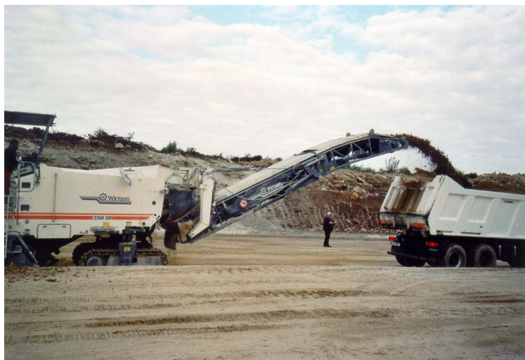
Pilt 3.1. Firma Wirtgen freeskombaini katsetamine Põhja-Kiviõli karjääris. Vasakul – näide, et kombaini töösügavus on täpselt reguleeritav; üleval - kaevisse laadimine kallurile.
