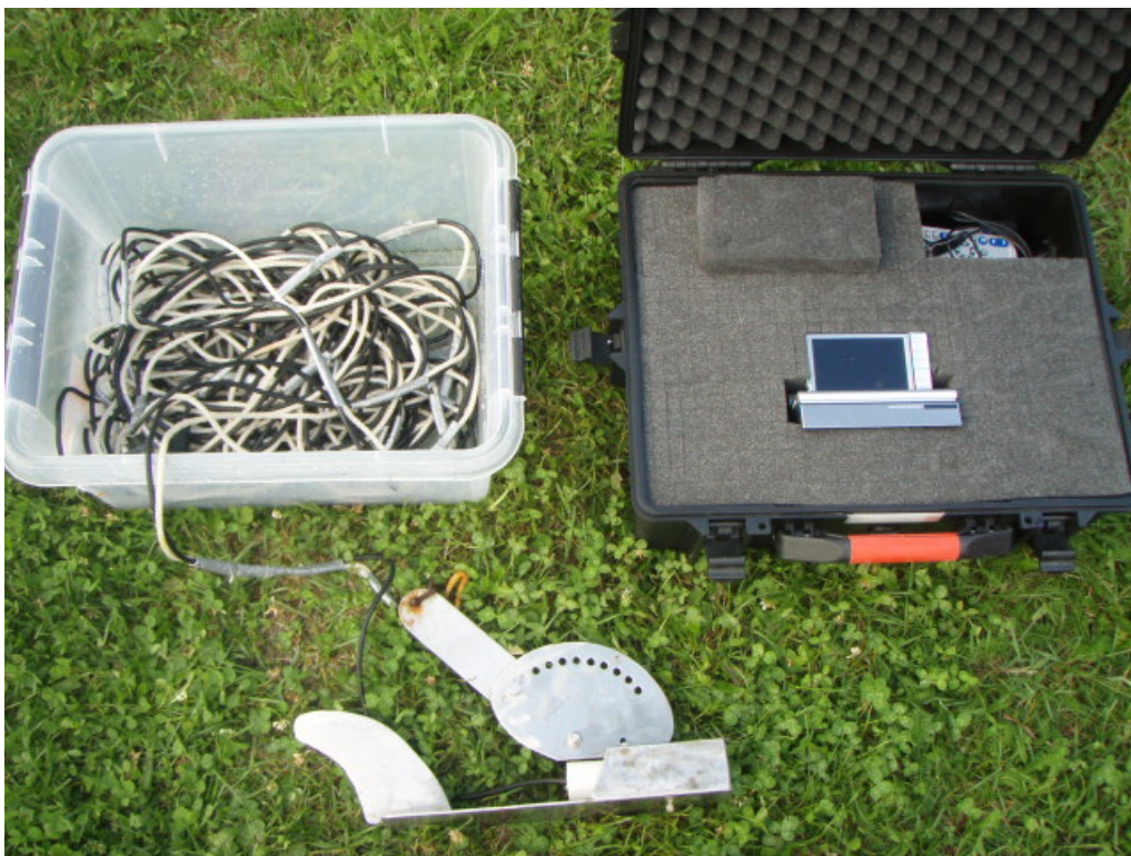
Foto 1. Merepõhja kaardistamisel kasutatud allveevideosüsteem.
